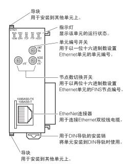
连接到Ethernet网络的每个通信设备都被分配以一个唯一Ethernet地址。对于Ethernet单元,Ethernet地址作为12位十六进制显示在单元的右侧。
