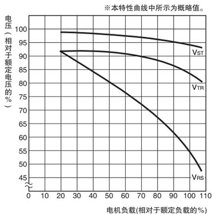
注: 图中所示为R相缺相时的情况。Vst、Vtr、Vrs为缺相时电机端子上的电压。
