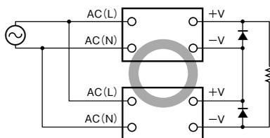
注1. 负载短路时, 产品内部会承受反向电压。偶尔可能导致产品老化或损坏, 因此请连接如图所示的二极管。选择二极管的大致标准如下。
