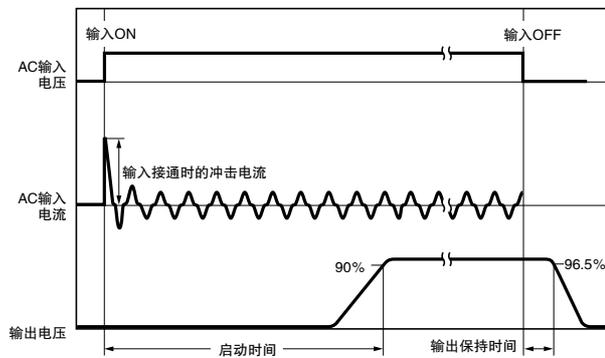
注. 冗余运行时，将流入通常数倍的冲击电流。特别要仔细确认保险丝的熔断特性和断路器的动作特性并加以选用，避免因冲击电流导致外接保险丝熔断或断路器启动。
