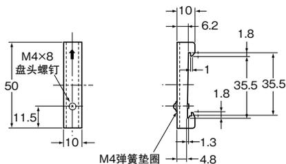
注1. 可能受到振动、冲击的用途中, 可能会因铝的磨损而产生金属碎屑, 这种情况下请使用铁制DIN导轨。
