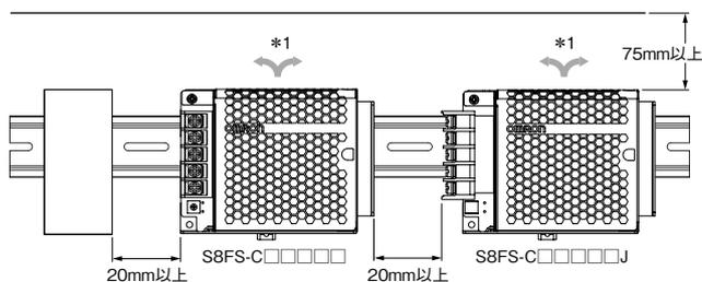
安装到DIN导轨上时，请将Ⓐ部挂到导轨的一端，并沿Ⓑ方向按入，直至听到“咔嚓”一声。请确认配件的卡爪已经挂在DIN导轨上。
