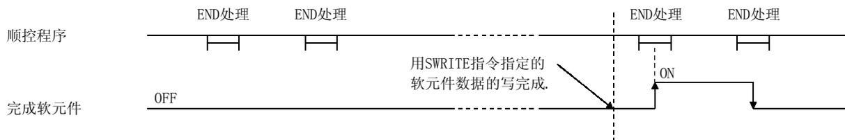
(5) 如果使用 J.SWRITE/G.SWRITE 执行指令，则在读命令为 ON 时，一个读处理完成后接着执行下一个读处理。
