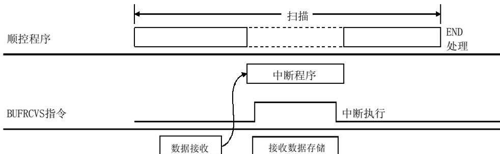
(2) Z.RECVS 指令用在中断程序中, 并且它的处理在一次扫描内完成。
