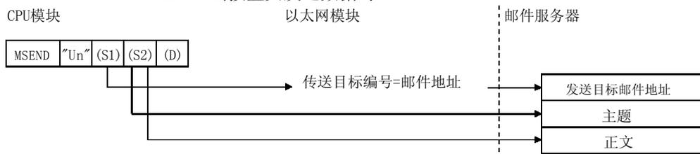
(2) 可以用设定数据中指定的完成软元件 (D) 或完成状态显示标志 ((D) + 1) 检查是否正在执行 MSEND 指令或正常/异常完成。
