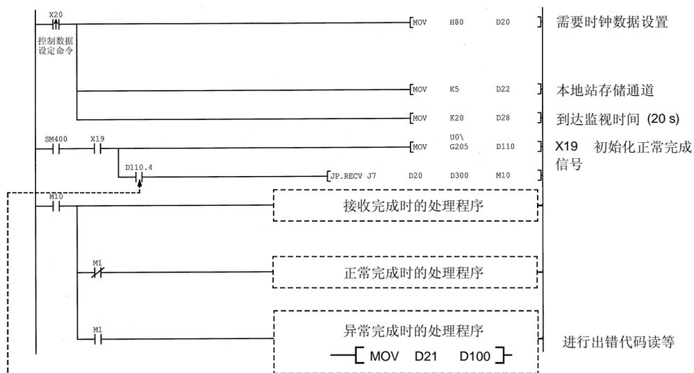
当数据存储在接收通道中时 对应缓冲存储器 RECV 指令执行请求区各个通道的位变为 ON 该信号用于接收命令时可以自动读数据 当 RECV 指令完成时信号变为 OFF
