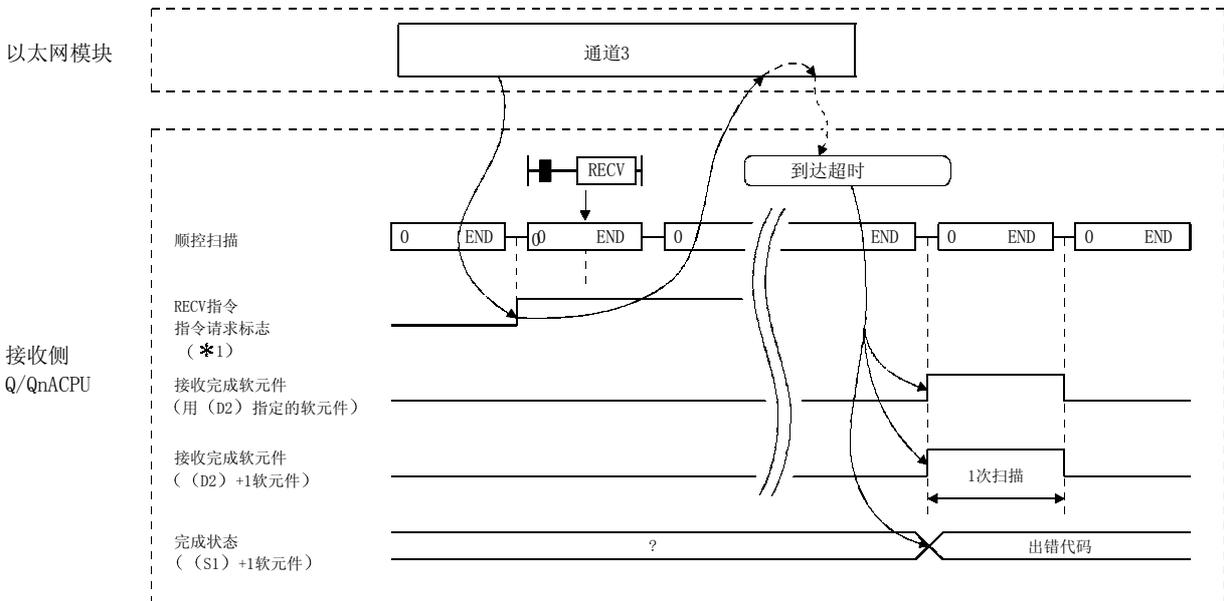
\*1 在接收侧 Q/QnACPU 使用的通道 3 的 RECV 指令执行请求标志如下所示：
